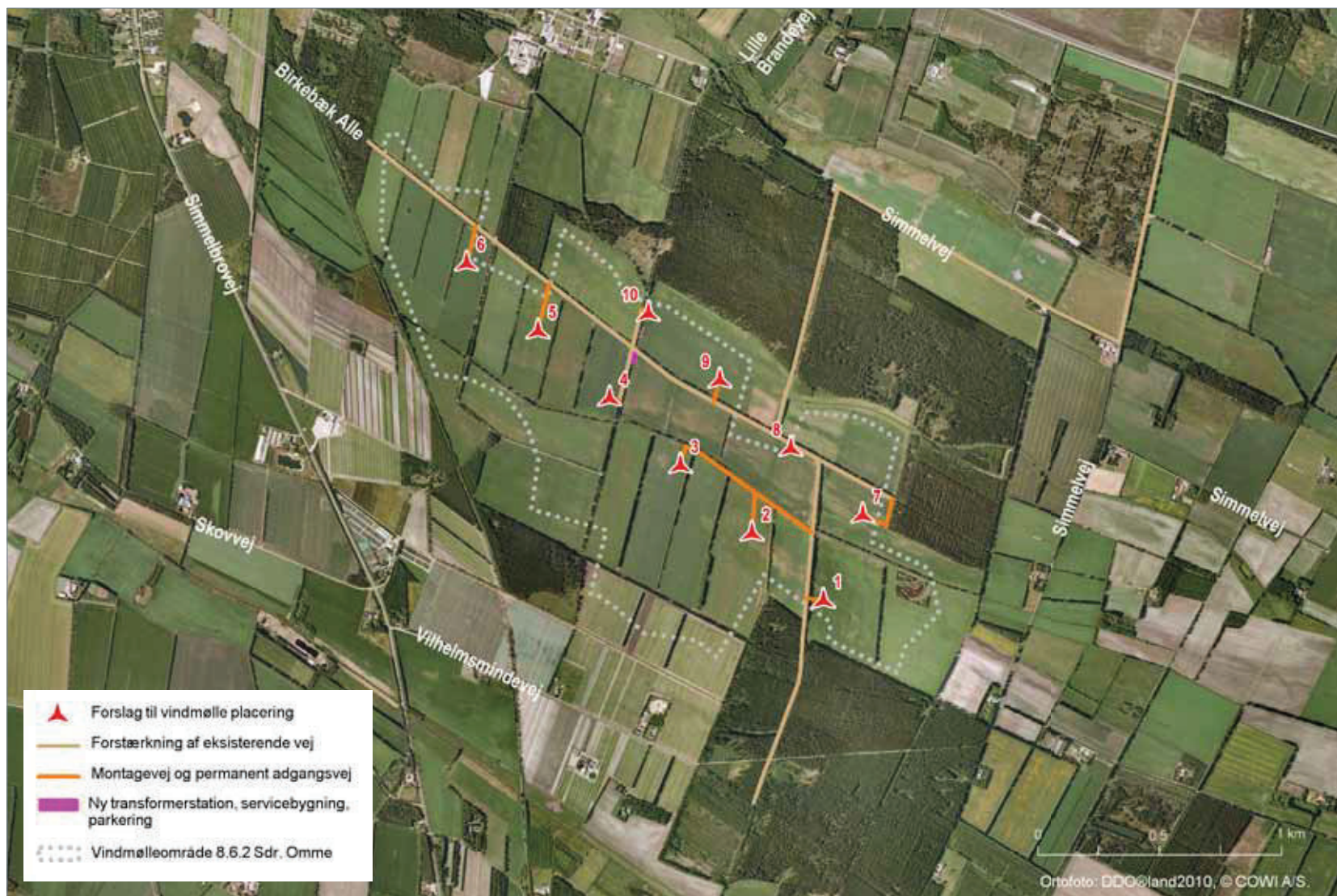
Figur 2-2: Luftfoto af vindmøller ved Sdr. Omme (10 Vestas V 112 møller med en totalhøjde på 149,9 meter). Vindmølleområdet og adgangsveje er indtegnet.
